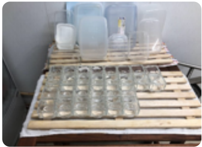
容器に充填する前に洗浄し、容器破損が無いかも確認する。
