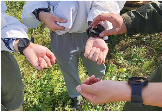
腕時計タイプの活動量計で、作業負荷を測定しながら無理のない作業プログラムを組み立てる
